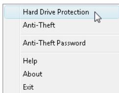
La sélection de cette fonction interrompra les transactions de données au disque dur lorsqu'une vibration ou un mouvement qui dépasse le niveau toléré par le disque dur est détecté.
