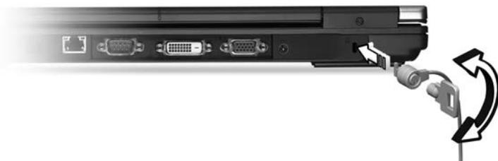
Enroulez le câble du cadenas de sécurité pour ordinateur autour d'une table, de la poignée d'un tiroir verrouillé, ou de tout autre objet fixe. Insérez le cadenas dans l'encoche et tournez la clef pour verrouiller le cadenas. Certains modèles ne possèdent pas de clef.
