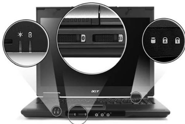
Les indicateurs d'état de l'alimentation, de la batterie, du Bluetooth et de la communication sans fil sont visibles même lorsque l'écran LCD est fermé.
